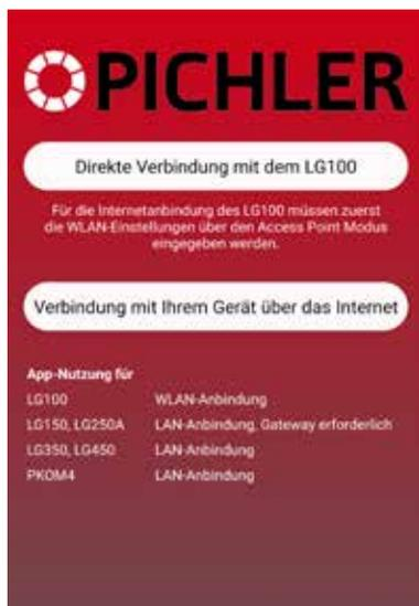
Drücken Sie den Button „LG100 Access-Point“ um eine direkte Verbindung mit dem Lüftungsgerät herzustellen.
