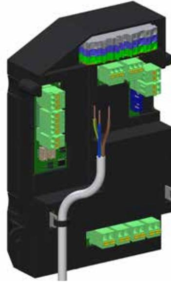
Netzzuleitung mittels Kabelbinder fixieren
